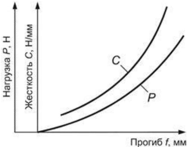
Жесткость пружины , Н/мм, определяют, как минимум, в пяти точках зависимости нагрузки от прогиба как производную .
